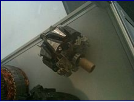
Rotor eines Klauenpol-Kfz-Generators mit Lüfterrad auf der Welle.
