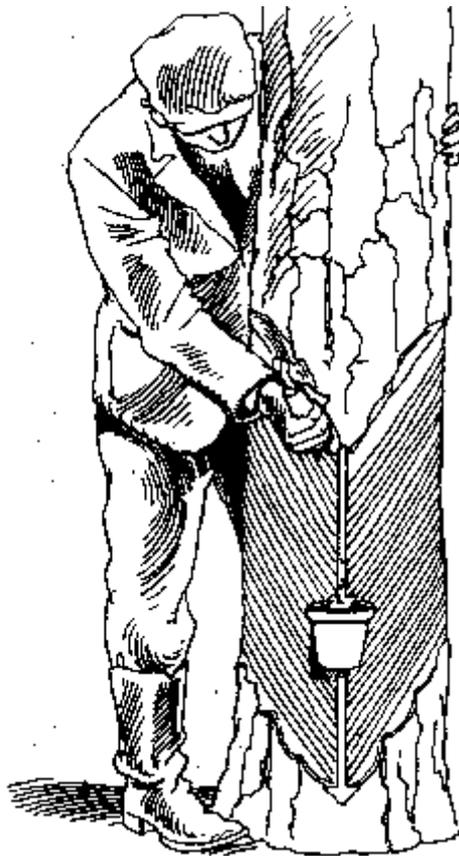
Die sog. "Lichte".  $2 \times 35^\circ$  Winkel, 35cm Länge, in der Mitte die senkrechte Flußrinne. Die mit dem obigen Instrumentarium hergestellte, Harz absondernde Stammfläche (unter der Rinde)
