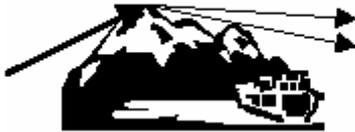
Radiowellen werden an Kanten von Hindernissen von der ursprünglichen Ausbreitungsrichtung abgelenkt. Damit lassen sich Empfänger erreichen die hinter Bergen liegen.
