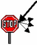
Bei der Streuung wird ein Signal an einem Objekt in mehrere schwächere Signale aufgespalten, die in verschiedene Richtungen weiterlaufen.
