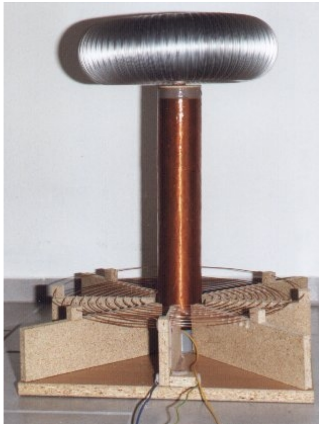
Abb.27: In der Primärspule stehende Sekundärspule
