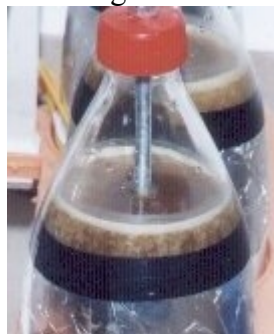
Abb.17: Blasenbildung im Öl des Salzwasserkondensators
