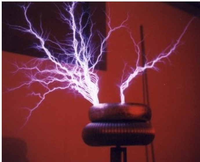
Abb.31: Hier dient der Styroporkern-Torus als Entladungs Elektrode (K2)
