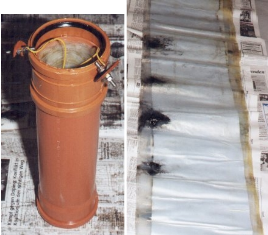
Abb.15: Geöffneter Folienkondensator Abb.16: Entrollter Folienkondensator
