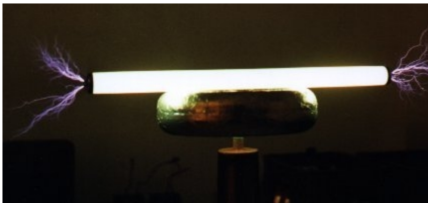
Abb.36: Eine auf dem Entladungsterminal platzierte Neonröhre ergibt einen Interessanten Beleuchtungseffekt (KI)
